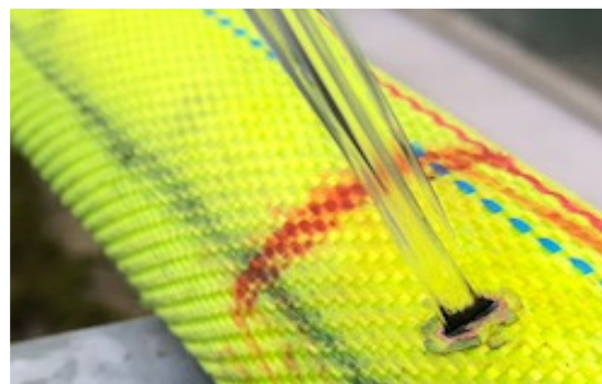
Bild 2: Wasseraustritt durch Beschädigung
